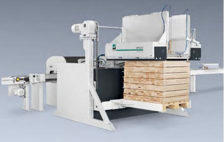
Der **OptiCut Stacker** ist die ideale Lösung bei der Produktion von Vorzugslängen. Diese werden vollautomatisch gestapelt, bei einer Stapelhöhe von 1200mm und einer Frequenz von bis zu 80 Teilen/min. Unterschiedliche Stapelbilder können hierbei in der Sägesteuerung gewählt werden.
