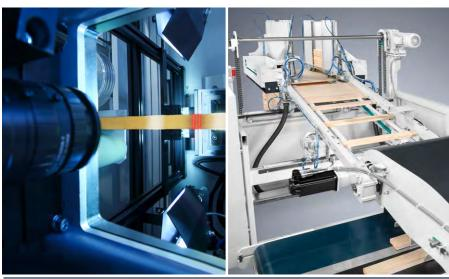
WEINIG Scannersysteme erfassen blitzschnell und vollautomatisch die entsprechenden Werkstückeigenschaften wie Äste, Risse und Strukturverläufe und versorgen bei voller Produktionsgeschwindigkeit über intelligente Mechanisierungen bis zu 4 OptiCut Hochleistungssägen mit den Daten für den Zuschnitt.
