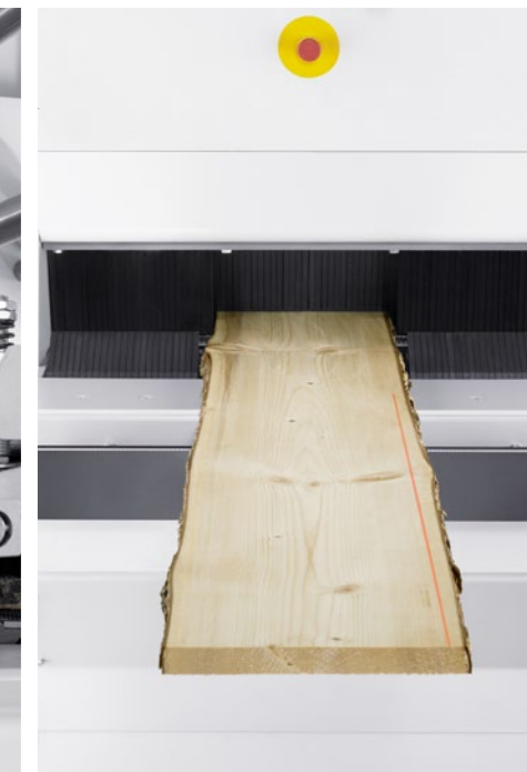
Laser zur Schnittanzeige: sehen, was gesägt wird
