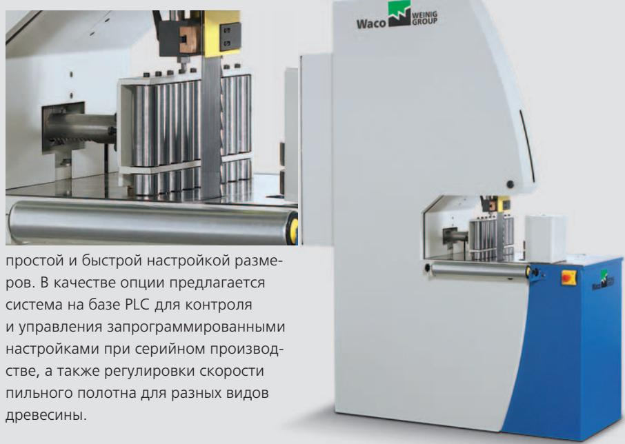
простой и быстрой настройкой размеров. В качестве опции предлагается система на базе PLC для контроля и управления запрограммированными настройками при серийном производстве, а также регулировки скорости пильного полотна для разных видов древесины.
