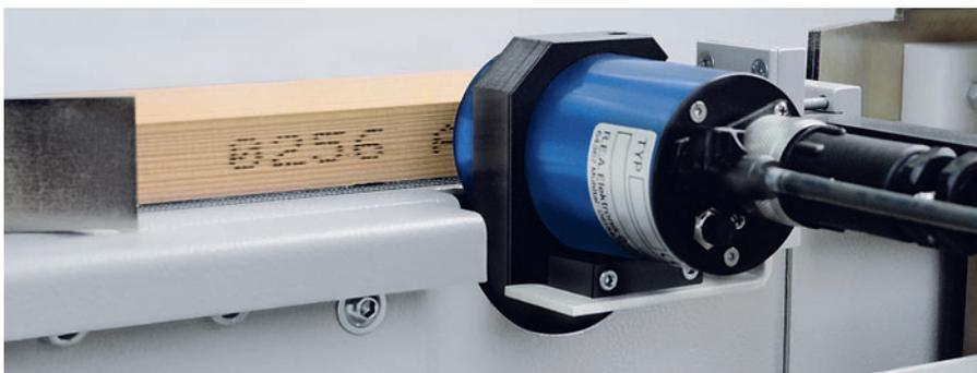
На каждую деталь, выходящую из станка, наносится код – либо путём непосредственной печати, либо в виде наклейки.
