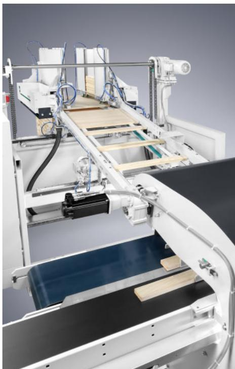
**Принтер для наклеек**, как составная часть системы управления установки OptiCut S 90, печатает штрихкоды на этикетках, которые автоматически наклеиваются на готовые детали. Отслеживаемая по штрихкоду информация о каждой детали передаётся через систему управления к станкам, на которых будет вестись дальнейшая обработка, и те своевременно перенастраиваются. Оформлять этикетки можно как угодно.
