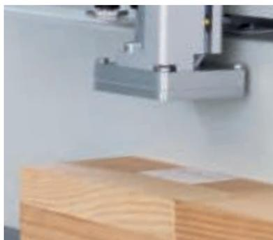
Mit dem **Etikettendrucker** können Etiketten vollautomatisch erstellt und aufgebracht werden. Der Drucker ist dabei voll in die Steuerung der OptiCut S 90 integriert. Über den Barcode wird die Teileidentifikation sogar maschinenlesbar und weitere Prozessmaschinen können sich entsprechend auf das Werkstück einstellen. Individuelle Etikettendesigns sind hierbei kein Problem.
