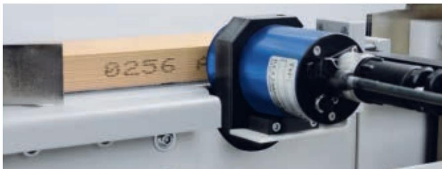
Für die zweifelsfreie Identifikation der Teile nach dem Schnitt werden Inkjetdrucker oder Etikettendrucker eingesetzt.
