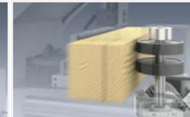
Frequenz geregelter, stufenloser Vorschub 5 - 40 m/min
