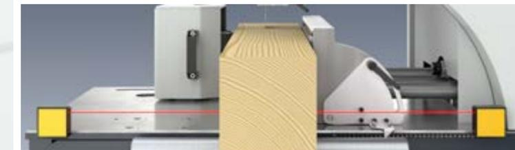
Automatische Breitenmessung des Werkstücks zur Positionierung der Vorschubrollen und des Breitenanschlags zur Steigerung der Produktivität
