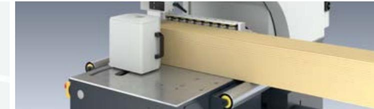
Auflagerolle: erleichtert die Zuführung besonders bei langen, schweren Werkstücken
